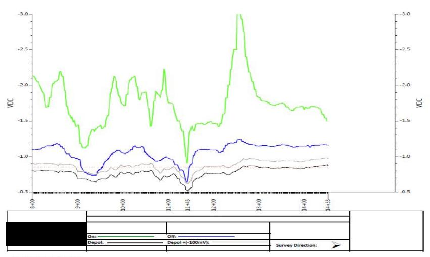
Vertical Scale: 0.0vDC - (-3.0) Horizontal Scale: 1 Inch = 100Ft
